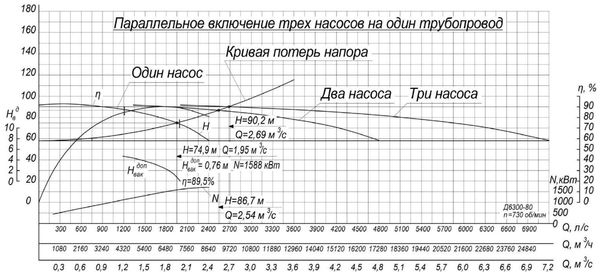
Рисунок 2.6 – Фактические рабочие параметры насоса Д 6300-80 с тремя линиями всасывающего трубопровода и двумя нитями напорного трубопровода (при работе трёх насосов на один трубопровод)
