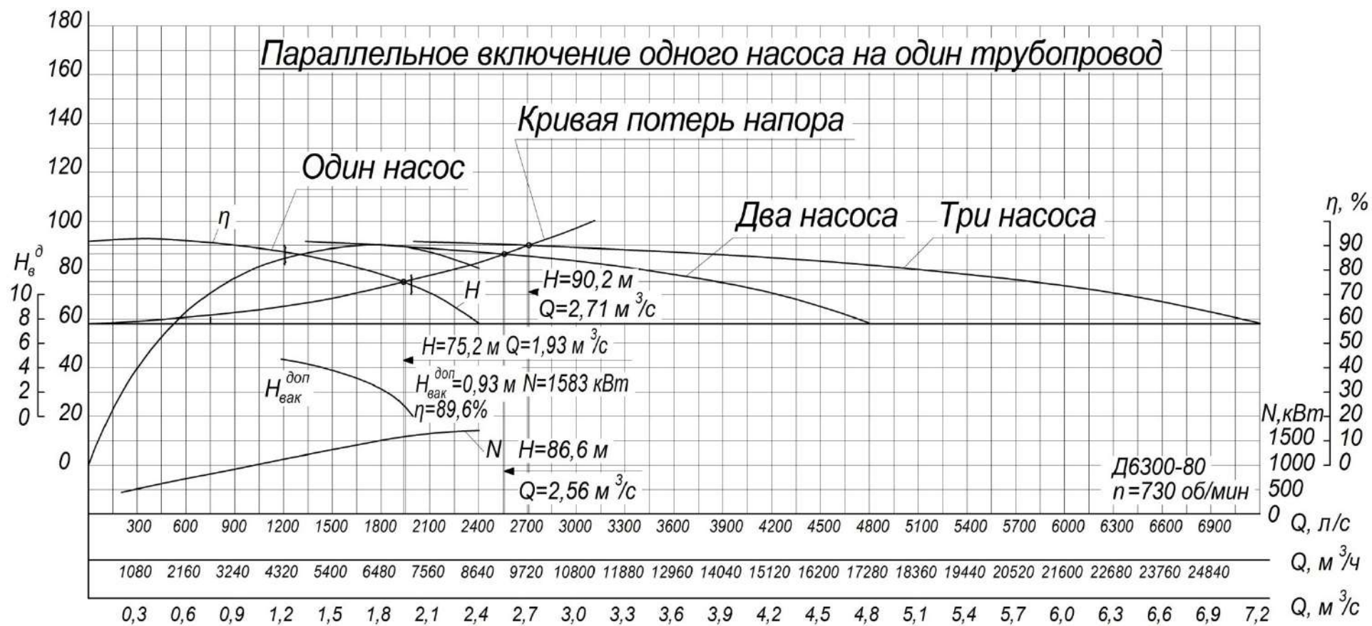
Рисунок 2.4 – Фактические рабочие параметры насоса Д 6300-80 с тремя линиями всасывающего трубопровода и двумя нитями напорного трубопровода (при работе одного насоса на один трубопровод)
