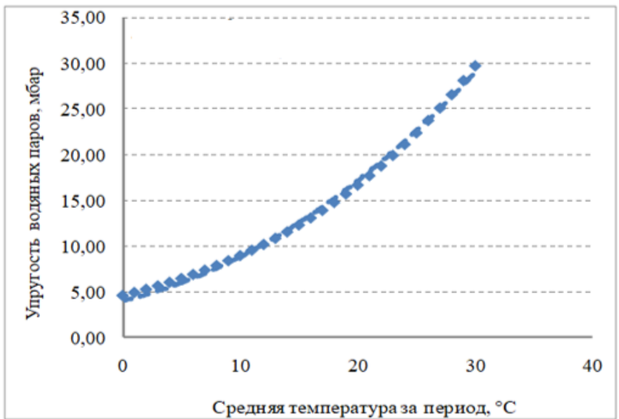
Рисунок 3.15 – График упругости насыщенного пара в зависимости от температуры воздуха, в миллибарах
