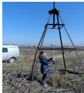
Рисунок А 1 – Привязка планово-высотной сети к исходным пунктам триангуляции у ПМК
