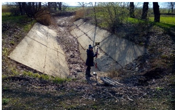
Рисунок А 1 – Привязка планово-высотной сети к исходным пунктам триангуляции у ПМК
